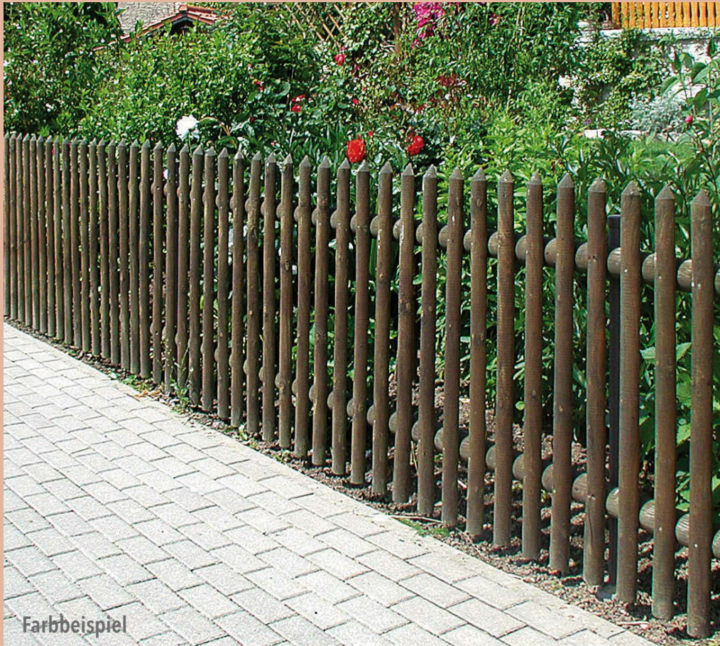
Senkrechtzaun halbrund gefräste Latten 6,0 cm breit, Spitzen gekegelt, kesseldruckimprägniert Riegel 8 cm, Felder und Tore fertig montiert, verzinkt genagelt
